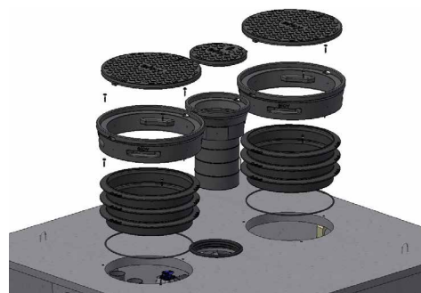
AVEC REMBLAI > 20 CM utilisation de rehausse recoupable
