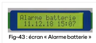
Cette alarme signale que la pile AA (type « crayon ») rechargeable interne au boîtier est soit déchargée, soit mal positionnée. Cette pile est indispensable au bon fonctionnement du boîtier, elle permet notamment d'avertir l'utilisateur d'un défaut d'alimentation principale (voir point suivant).
