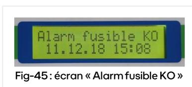
Le circuit électronique interne du boîtier de centralisation des défauts est protégé par un fusible de calibre 3,15A. Cette alarme signale un défaut au niveau du fusible. Ce défaut peut être dû :
