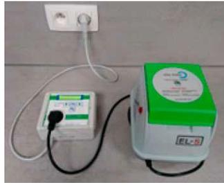
Fig-18 : raccordement électrique classique
