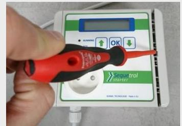
3. Localiser la pile et le collier de maintien. Ouvrir celui-ci en appuyant sur la languette de maintien.
