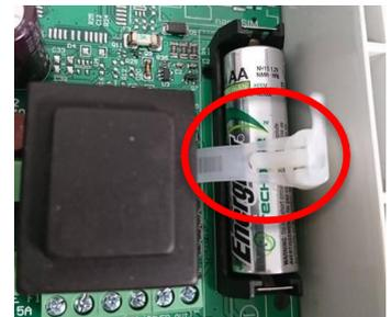
4. Extraire la pile, et la remplacer par une neuve **identique**. Sécuriser sa position en serrant le collier.
