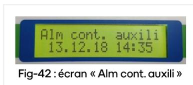
Cette alarme signale un problème au niveau d'un des contacts auxiliaires du coffret de commande, soit du magnétothermique de protection du surpresseur, soit du disjoncteur de protection de la pompe. Ce défaut peut-être dû :
