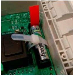
Fig-17 : languette rouge pour batterie
