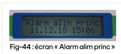
Cette alarme signale une perte d'alimentation principale au niveau du boîtier de centralisation des défauts. Ce défaut peut être dû :
