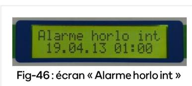
Le boîtier de centralisation des défauts est équipé d'une pile « bouton » 3V pour la mémorisation de l'horloge interne. Ce défaut apparaît lorsque la pile est usagée, ou mal positionnée.
