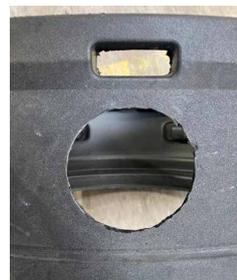
2. Installer le joint d'étanchéité au niveau du percement réalisé.
