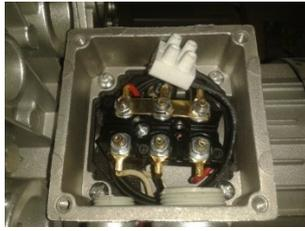
Fig-10 : exemple de montage pour une moteur triphasé 3x400V
