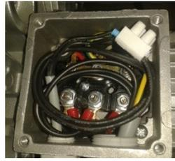
Fig-11 : fils thermosonde
